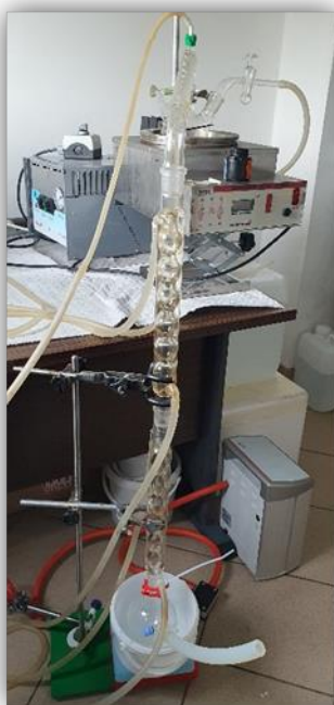
Rysunek 14. Zestaw do destylacji z parą wodną według mojej koncepcji.
